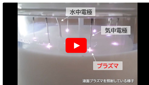
図1 液面プラズマ分散技術 概略図
